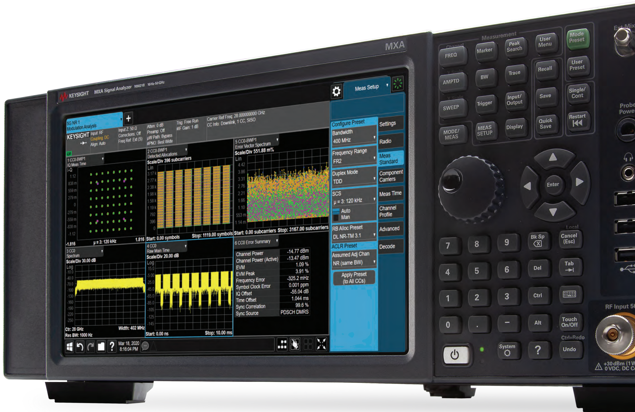
装有 PathWave 5G NR 测量应用软件的 N9021B MXA 信号分析仪
